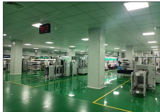
SMT 工段（模块）自动化生产线
